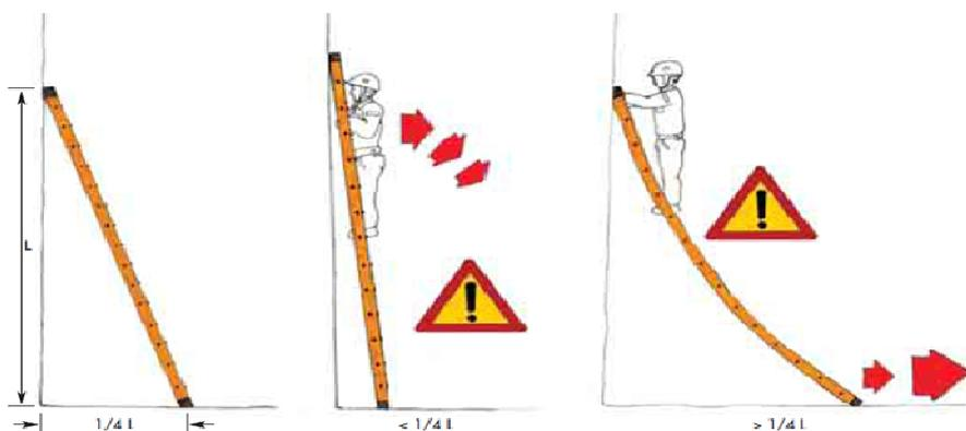
Effetto di una non corretta posizione di una scala in appoggio
